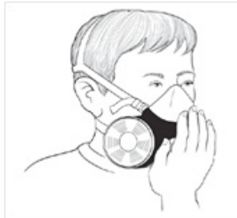
Prueba de Presión Positiva Máscara de Rostro Completo (Filtros con ajuste tipo rosca)
