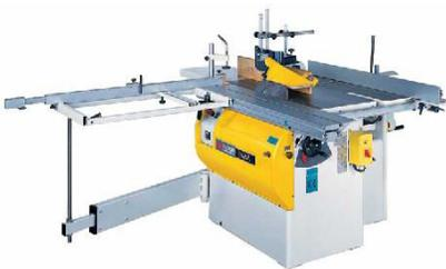
**3.1.2. Sierra Circular:** Utilizada para cortes de madera de distintos espesores. La sierra circular asoma por la mesa de trabajo donde es sostenida la mesa y puede ser deslizada manualmente. La sierra circular puede variar su ángulo para efectuar de cortes angulares. Todo el mecanismo es movido por un motor eléctrico. Cuenta con protección eléctrica y resguardos en sistema de correa de transmisión.
