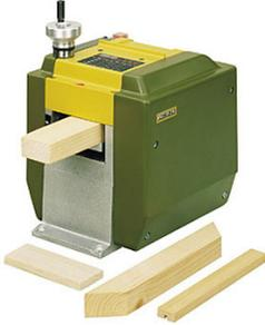
**3.1.5. Cepilladora Cerrada:** Se utiliza para reducir de espesores de la madera. Comprende un tambor que dispone de cuchillas de corte y volantes dentados de arrastre. Todo este mecanismo está encerrado en una carcasa robusta. A su vez, todo el mecanismo posee reguladores y controles para su buen desempeño. Todo es movido por un motor eléctrico, contemplando interruptores de seguridad y conexión a tierra.
