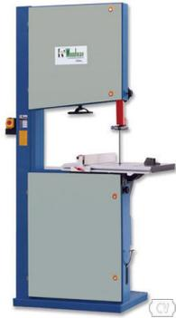
**3.1.1. Sierra Cinta:** Es una máquina utilizada para cortes rectos y curvos de variado espesor, constituido por dos volantes que permite hacer desplazar una cinta metálica con dientes, para realizar el corte de la madera sobre una superficie de trabajo. Esta sierra es movida por un motor eléctrico. Para su seguridad se aloja interruptores con protección eléctrica y correas con resguardos.
