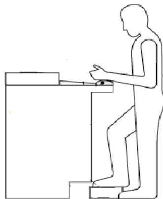
La figura muestra la forma de apoyar las extremidades inferiores en un taburete
