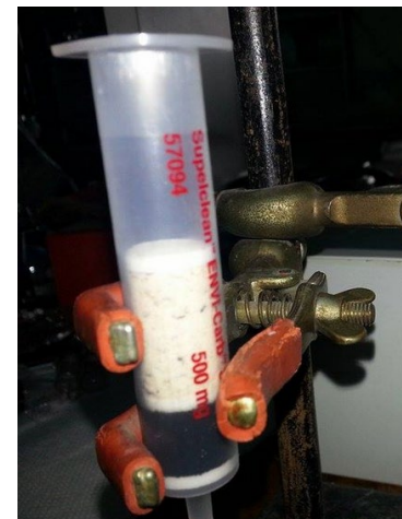
Figura 1. Fotografía que muestra la mezcla de abejas + fase C18 empacada sobre la columna de carbón grafito antes de la elusión con solvente.
